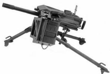
Conçue à partir de la mécanique de la Browning 1919, cette mitrailleuse lance désormais des grenades de 40mm. Toutefois, la rafale est purement conceptuelle car en tir continu, cette arme ne projette au plus que 3 grenades par tour.
